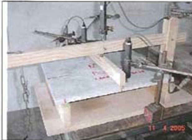
Fotografía 3.1: Placa Aislaforte. Placa montada antes del ensayo de flexión.
