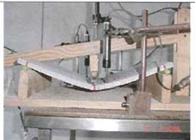
Fotografía 3.2: Placa Aislaforte. Placa una vez finalizado el ensayo de flexión.
